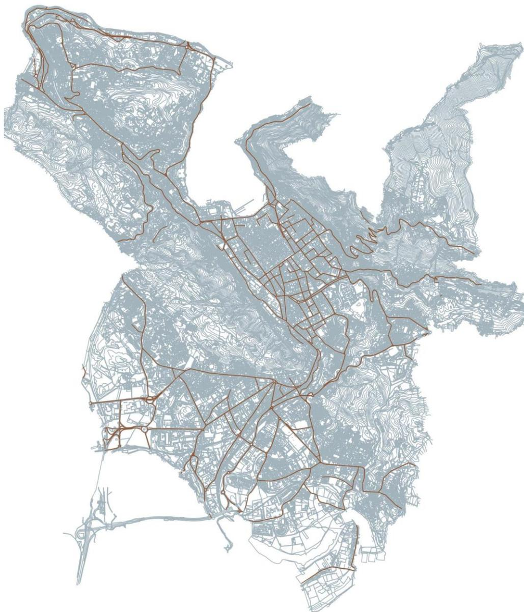
Fig. 11.5 Scenario di riferimento – rete interessata ad una emissione a 10 mt di 65 dBA nell'ora di punta del mattino
